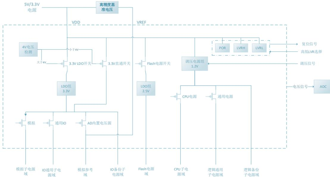
电源管理控制器（PMU）为软件提供了电源方面的系统管理功能，包含睡眠/深度睡眠/唤醒功能的控制，电源监测功能（LVR/LVD/HVD）。
